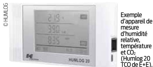
Exemple d'appareil de mesure d'humidité relative, température et CO<sub>2</sub> (Humlog 20 TCO de E+E).
