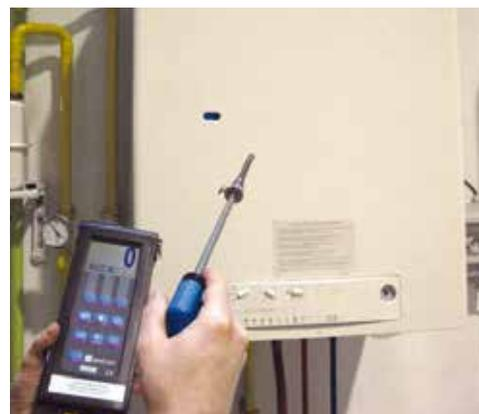
Mesure du taux de monoxyde de carbone dans l'air ambiant à proximité de l'appareil en fonctionnement.
