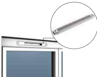
**!** Vérifier la présence d'entrées d'air, soit dans la maçonnerie, soit dans la menuiserie. L'air neuf est pris directement à l'extérieur.
