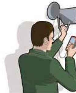
Mesure avec un cône et un anémomètre étalonné.
